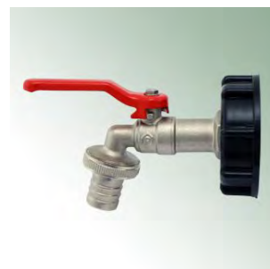
Kugel-Auslaufventil (IBC Tank) Anschluss: 60 mm Grobgewinde Hahnabgang: 1" AG
